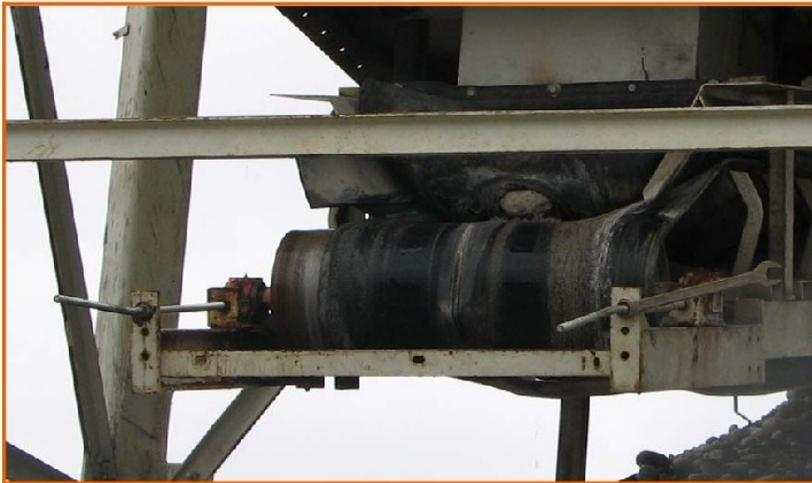
*“Della ghiaia che usciva dalla tramoggia era finita nella parte interna del nastro trasportatore a causa del fatto che il nastro, spostandosi dalla sua sede, aveva creato un varco tra la bavetta di contenimento e il nastro”.*
