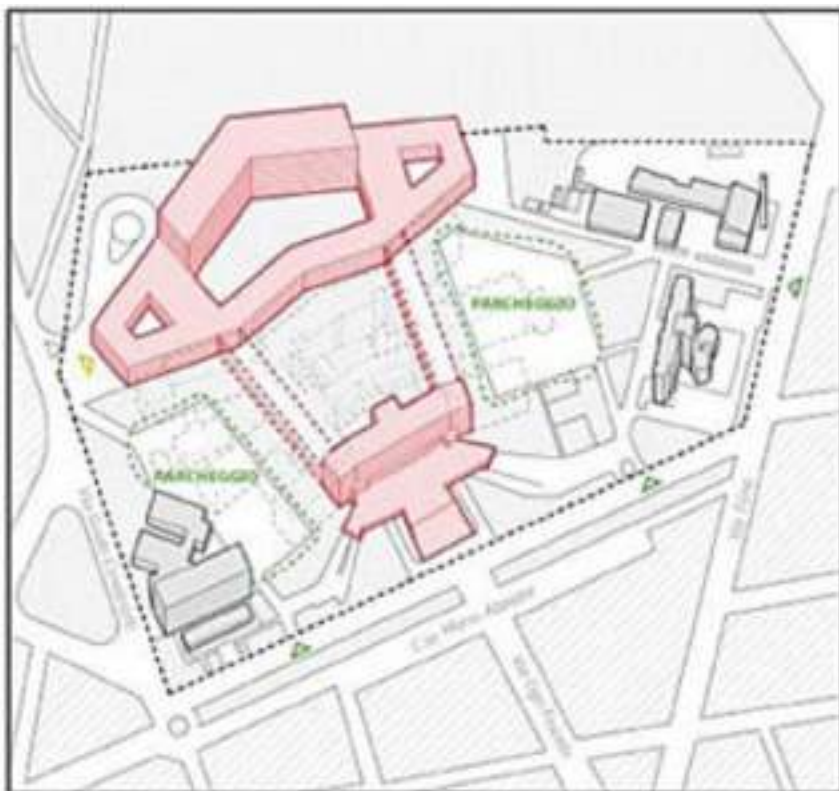
FASE 3: Demolizione Presidio Ospedaliero esistente e ristrutturazione facciata storica
